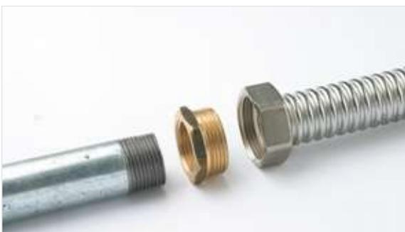
Esempio: tubo liscio DN 25 con filetto maschio da 1" accoppiato a tubo corrugato DN 25 con dado filettato da 1 1/4"
