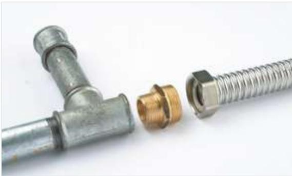
Esempio: tubo liscio DN 25 con filetto femmina da 1" accoppiato a tubo corrugato DN 25 con dado filettato da 1 1/4"
