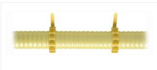
In particolari situazioni quali l'attraversamento di intercapedini chiuse o di vani o ambienti classificati con pericolo d'incendio, le tubazioni CSST possono essere utilizzate purché siano posizionate all'interno di un tubo guaina con dei distanziatori forniti da EUROTIS per il sostegno ed il centraggio.
