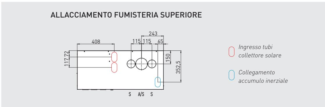
**Attenzione:** per l'uscita con fumisteria concentrica orizzontale Ø 60/100 è sempre necessario utilizzare il kit tronchetto flangiato Ø 60/100 (cod. 3.012086) ed il kit curva Ø 60/100 (cod. 3.012093), sul lato sinistro del telaio da incasso è possibile effettuare solo lo scarico dei fumi con tubazioni dell'Ø 80.
