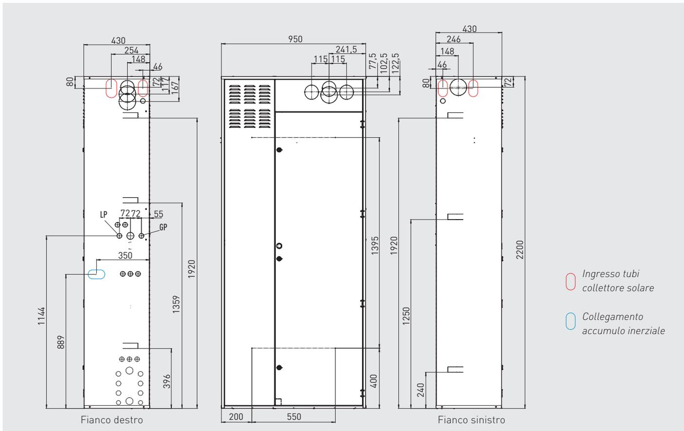
**Attenzione:** gli allacciamenti gas R32 (GP e LP) possono essere effettuati unicamente sul lato destro del telaio da incasso.
