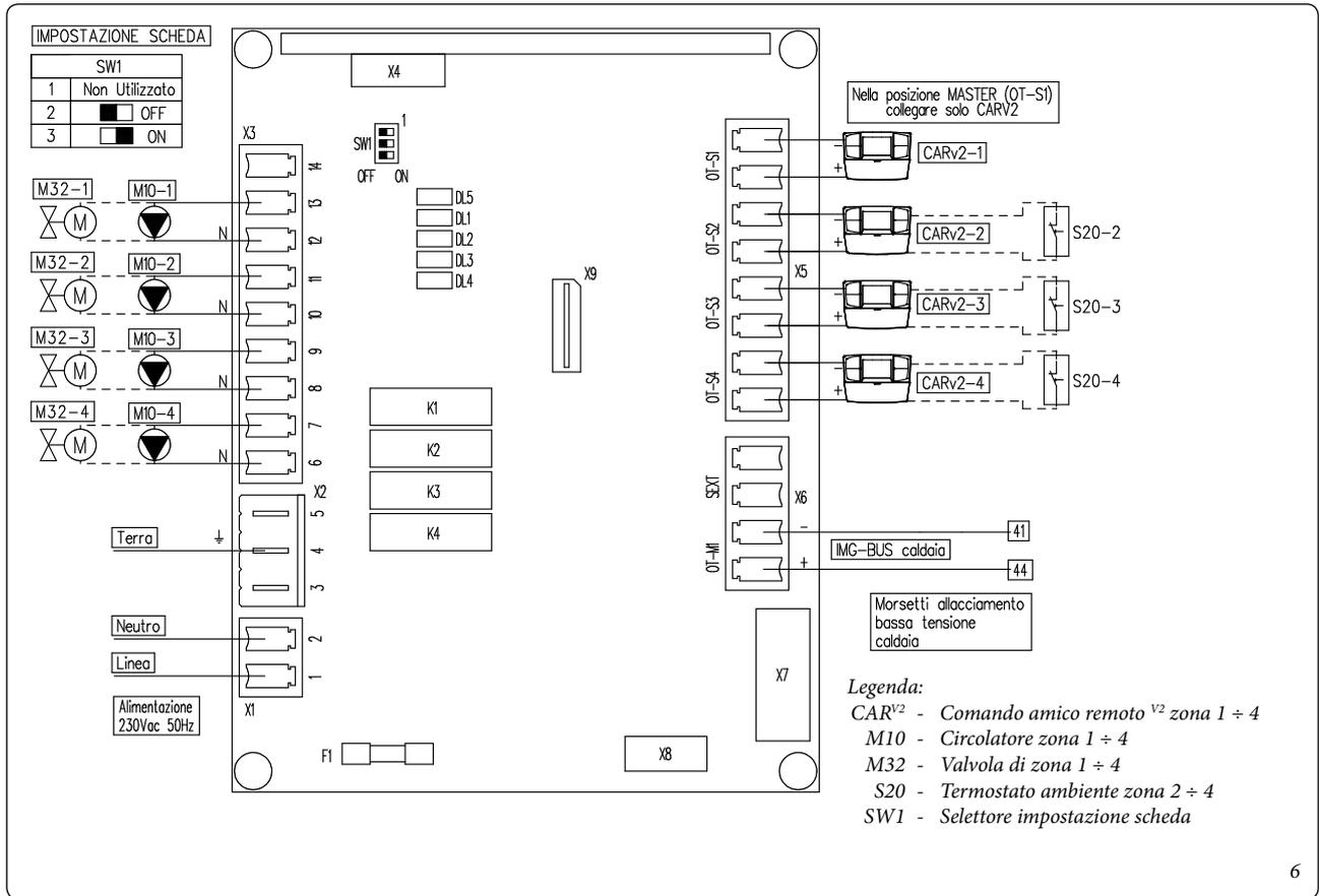
Schema elettrico kit multizone, configurazione 1
