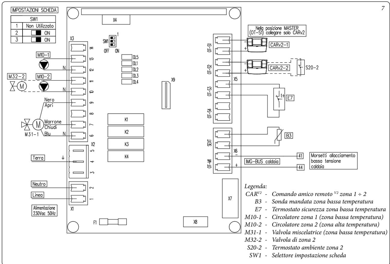
Schema elettrico 2 kit multizone, configura-
