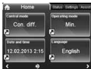
Fig. 17 Esempio del display principale di una pompa TPE serie 2000 con pannello di controllo avanzato
