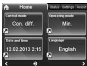
Fig. 2 Esempio del display principale di una pompa TPE serie 2000 con pannello di controllo avanzato
