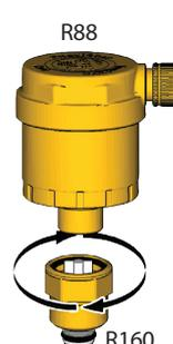
Avvitare la valvola automatica di sfogo aria al rubinetto R160, facendo in modo che la paletta in plastica sia guidata dal foro del corpo della valvola automatica di sfogo aria.
