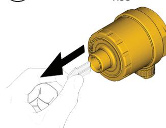
Dopo aver avvitato il rubinetto R160 sulla sede di installazione, rimuovere l'eventuale paletta in plastica presente sulla valvola automatica di sfogo aria e procedere con il montaggio.
