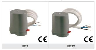
Le teste della serie R473 sono di tipo normalmente chiuso (NC); esse consentono l'alimentazione idraulica dei circuiti in presenza di tensione e dispongono di un cavo a due conduttori per il collegamento a termostati ambiente o centraline di regolazione
