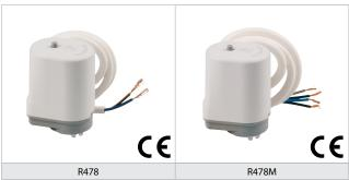
Le teste della serie R478 sono di tipo normalmente aperto (NA); esse consentono l'alimentazione idraulica dei circuiti in assenza di tensione e dispongono di un cavo a due conduttori per il collegamento a termostati ambiente o centraline di regolazione.
