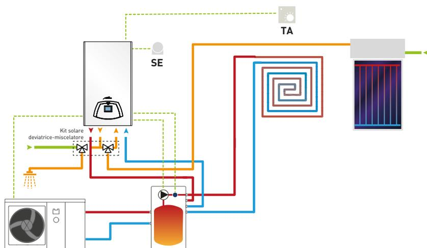
CALDAIA ISTANTANEA EDEA HM CON KIT HYBRID, SISTEMA SOLARE A CIRCOLAZIONE NATURALE E POMPA DI CALORE ARIA-ACQUA FINO A 12 kW
