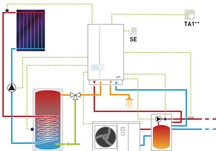
CALDAIA ISTANTANEA MURELLE HT CON KIT HYBRID, IMPIANTO SOLARE FORZATO E POMPA DI CALORE ARIA-ACQUA FINO A 12 kW
