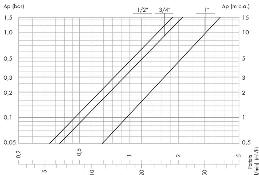
Portate consigliate per garantire funzionamento stabile e precisione  $\pm 2^\circ\text{C}$
