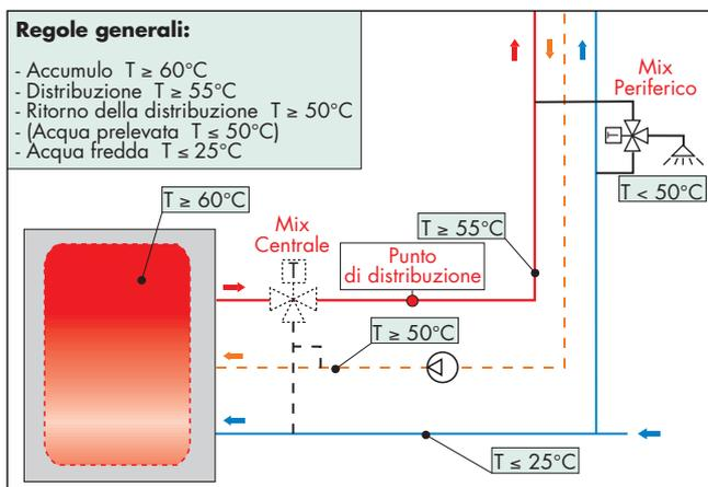
A fronte di tutto ciò, è quindi necessario installare sulla linea in uscita dall'accumulo dell'acqua calda, al punto di ingresso nella rete di distribuzione, un miscelatore termostatico che sia in grado di:
