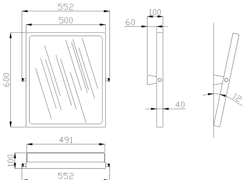
Specchio inclinabile, in vetro di sicurezza, munito di cornice in acciaio con finitura Rilsan®
