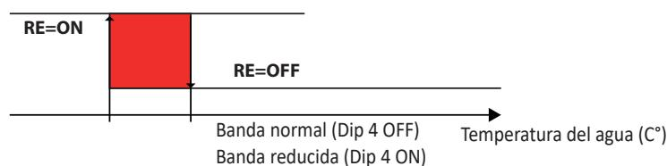
El funcionamiento de la resistencia eléctrica prevé fases de pre y posventilación relacionadas con su activación y desactivación.
