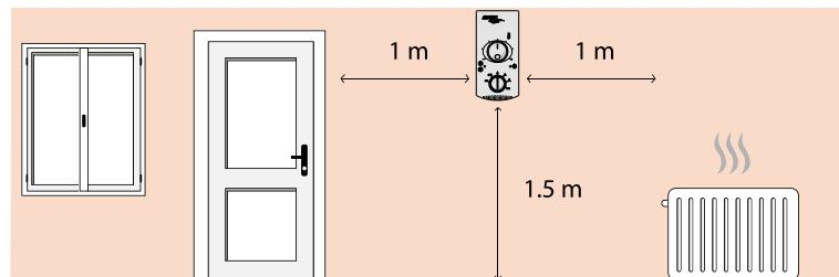
Para una instalación correcta, primero es necesario fijar la placa de montaje y luego la cubierta.
