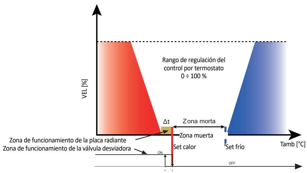
Como se puede ver en las figuras, al acercarse al setpoint calor, se desactiva la ventilación y queda activada la placa radiante. El valor  $\Delta t$  se puede configurar en el dip 2 de SW2 tal como se indica en la tabla de configuración del Dip-Switch SW2. La zona muerta que se indica en la figura puede corresponder a 2°C o 5°C dependiendo del valor configurado en el dip 7.
