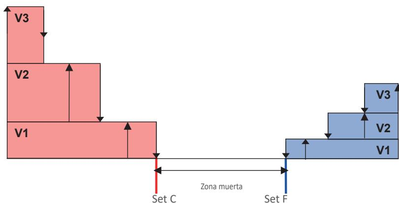
La zona muerta que se indica en la figura puede corresponder a 2°C o 5°C dependiendo del valor configurado en el dip 7.
