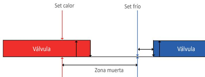
En la siguiente figura se muestra la lógica de funcionamiento de la válvula cuando el termostato utiliza la ventilación continua:
