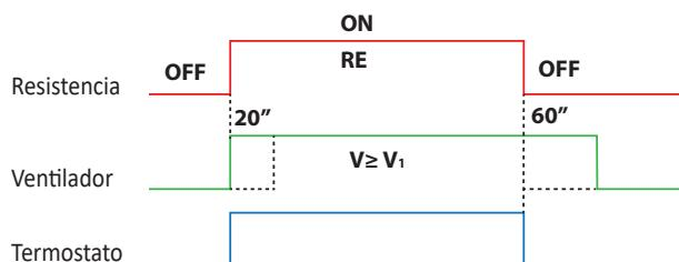
**Es necesario destacar que la fase de preventilación (de 20" a V1) se produce siempre con la activación de la resistencia eléctrica, mientras que la posventilación se ejecuta siempre durante su desactivación (de 60" a V1).**
