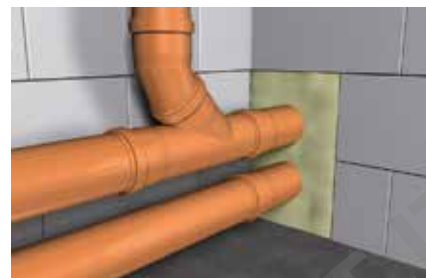
Riempimento di attraversamenti di tubazioni
