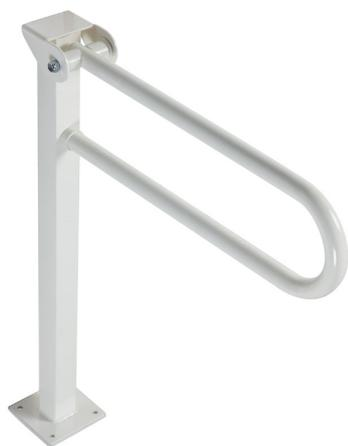
Impugnatura di sostegno ribaltabile, realizzata con tubo di acciaio zincato senza saldatura rivestito con vinile biocompatibile e caldo al tatto. Con colonnina per fissaggio a pavimento
